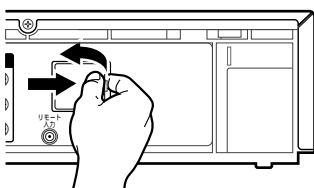
1. リチウム電池交換パネルを開ける
