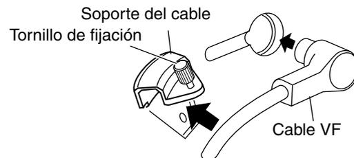
**3** Presione el soporte del cable directamente contra el visor y fije el tornillo de fijación.
