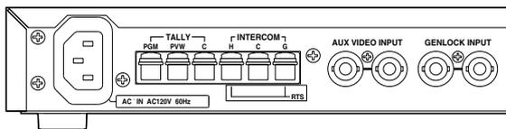
RM-HP790DE : 2-проводная система, для которой используются выходы [H] и [C]. \*1
