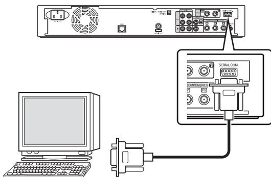
Mittels Anschluss eines RS-232C-Kabels an einen PC oder ein ähnliches Gerät ist die externe Bedienung möglich. Für ausführliche Informationen zur externen Bedienung siehe „Externe Steuerung (nur für SR-HD1700)“ (S. 90).
