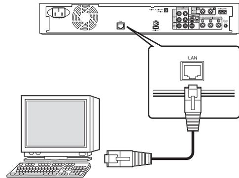
Die externe Bedienung kann durch Anschluss an einen PC oder ein ähnliches Gerät per LAN-Kabel aktiviert werden. Für ausführliche Informationen zur externen Bedienung siehe „Externe Steuerung (nur für SR-HD1700)“ (S. 90).
