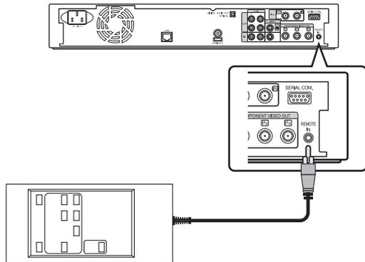
Die Benutzung eines Kabels ermöglicht die stabile Steuerung dieses Geräts über ein externes Gerät.
