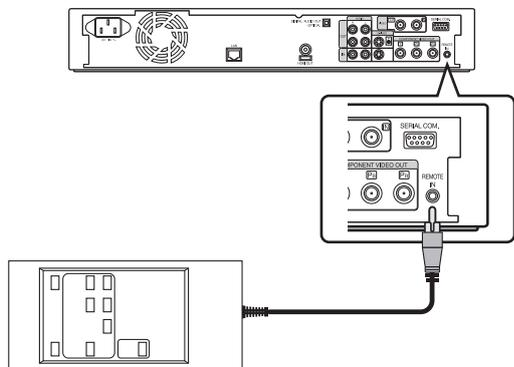
El uso de una conexión con cable permite un control estable del aparato desde un dispositivo externo.
