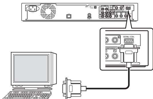
Se puede establecer el control externo de las operaciones mediante la conexión de un cable RS-232C a un PC o dispositivo similar.
