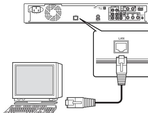
Se habilita el funcionamiento externo mediante la conexión a un PC u otro dispositivo similar mediante un cable LAN. Para más información sobre el funcionamiento externo, consulte la “Control externo (únicamente para SR-HD1700)” (p. 92).
