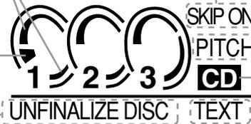
ファイナライズ\*<sup>1</sup>されていないCD-R/CD-RWディスクのときに点灯します。
