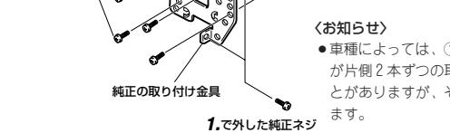
2. 本機に純正の取り付け金具を取り付ける
