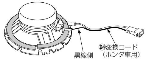
B. 車両側のコネクターに㉔変換コードのコネクターを接続する
