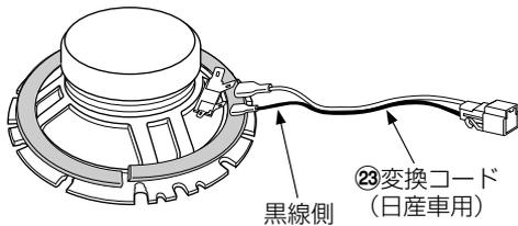
B. 車体に㉖ブラケット(日産車用)を取付け、車両側のコネクターに㉓変換コードのコネクターを接続する
