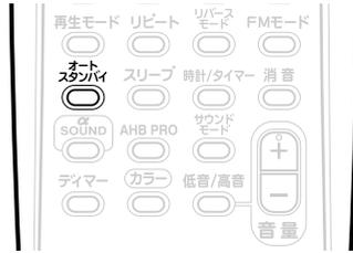
ラジオ(FM/AM)以外のソース(音源)のとき無音状態が3分以上続くと、自動的に電源が「切」になります。
