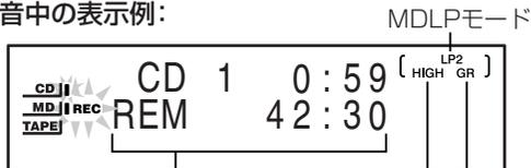
録音残量時間 倍速録音のとき点灯します。
