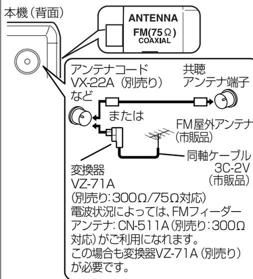
付属品以外のアンテナを接続する際の詳細については、アンテナおよび変換器の取扱説明書を参照してください。
