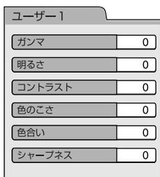
ガンマ: 画面の暗い部分と明るい部分の明るさを変えずに、中間の明るさを調節します。(設定範囲: -3 ~ +3)
