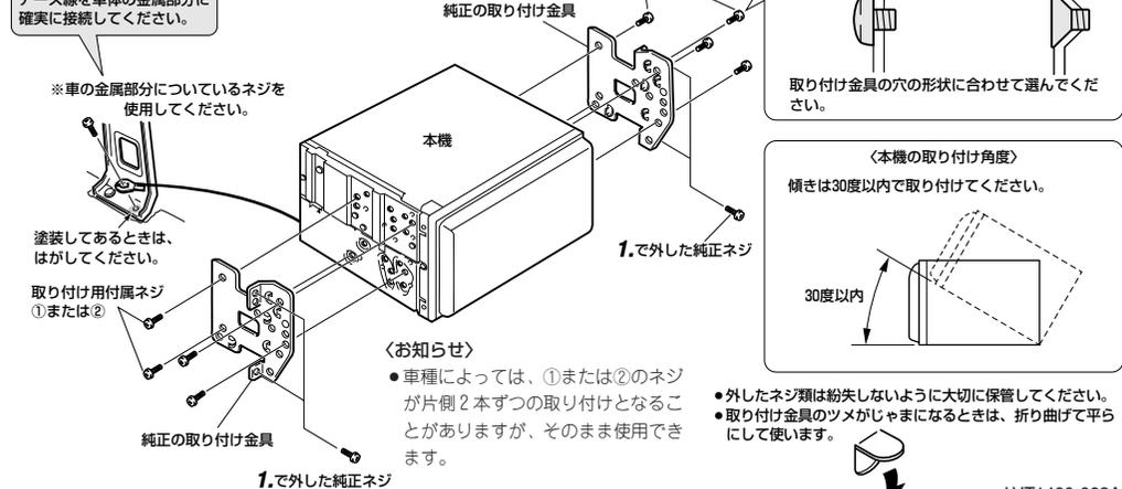
アース線を車体の金属部分に確実に接続してください。
