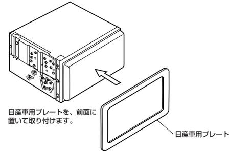
日産専用プレートを、前面に置いて取り付けます。
