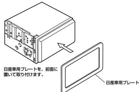
日産専用プレートを、前面に置いて取付けます。
