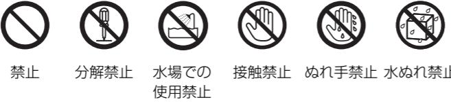
禁止 分解禁止 水場での使用禁止 接触禁止 ぬれ手禁止 水ぬれ禁止
