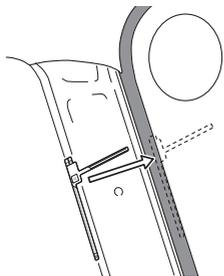
5. アンテナエレメントを押さえながらセパレータIをはがし貼り付けます。
