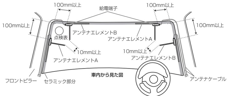
アンテナエレメントの給電端子がフロントガラス周縁のセラミック部分またはフロントピラーの端から25mm以内の位置になるように貼り付けてください。
