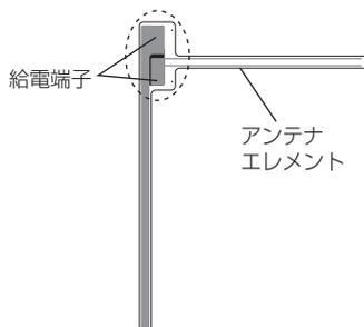
8. アンテナケーブル⑭のアンブ部裏面の剥離紙をはがし、アンテナエレメントの給電端子に、アンテナケーブルのアンブ部を貼り付けます。アンブ部の目印をアンテナエレメントの▲マークに合わせて貼り付けてください。
