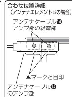
9. アンテナケーブル⑭を配線します。必要に応じてケーブルをソフトテープ⑯で固定して配線します。
