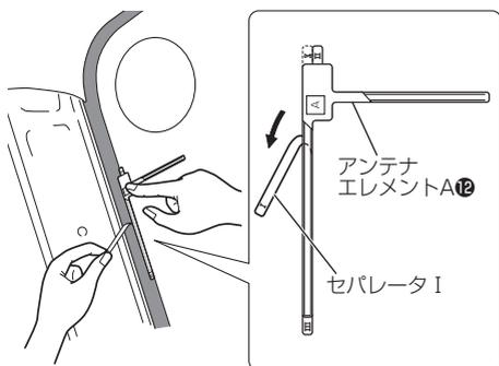
6. アンテナエレメントを押さえながらセパレータIIをはがし、アンテナエレメントを貼り付けます。
