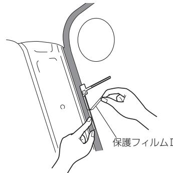
8. アンテナケーブル⑨のアンプ部裏面の剥離紙をはがし、アンテナエレメント⑧の給電端子に、アンテナケーブル⑨のアンプ部を貼り付けます。アンプ部の目印をアンテナエレメント⑧の▲マークに合わせて貼り付けてください。
