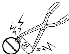
乾電池は絶対に分解、加工（はんだ付けなど）、充電、加熱、火中投入などをしない
