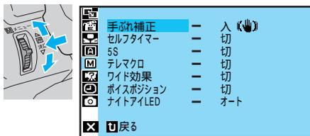
**6** レバーを上下に動かして「セルフタイマー」を選び、押して決定する
