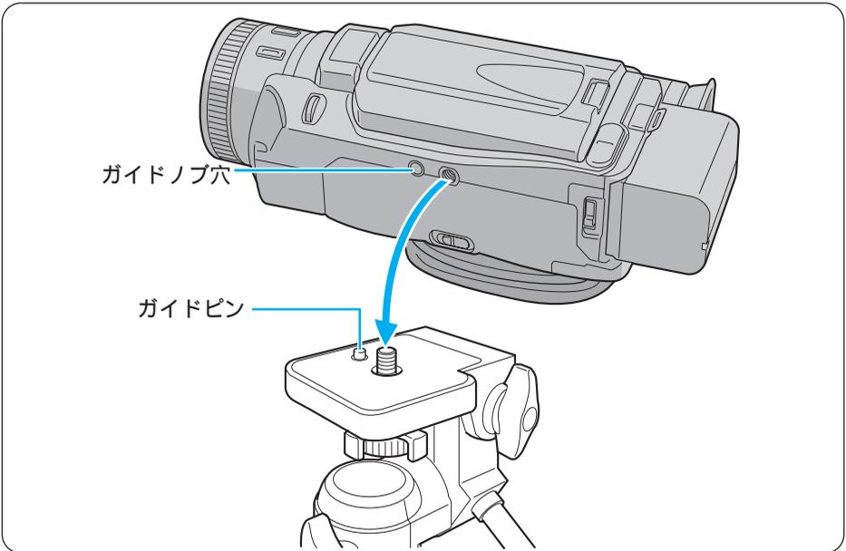
**1** 三脚のネジと本体底面のネジ穴を合わせる
