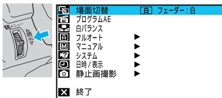
**4** レバーを上下に動かして「システム」を選び、押して決定する
