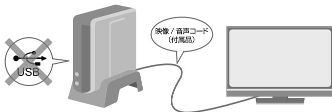
① USBケーブルをはずし、CU-VD40の電源を一度切ります。
