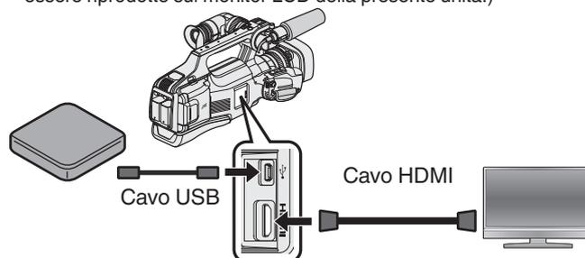
"Preparazione di un masterizzatore DVD (CU-VD3)" (pag. 78)
