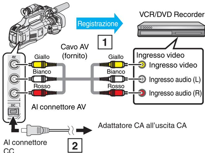
1 Eseguire il collegamento utilizzando il cavo AV in dotazione.
