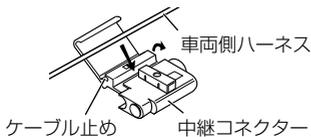
3.ナビ3信号変換ケーブルのリバース検出コードを中継コネクターに差し込みます。
