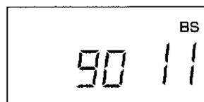
**6****BS入力レベルの数値が最大になるように、BSアンテナを動かして微調整する**
