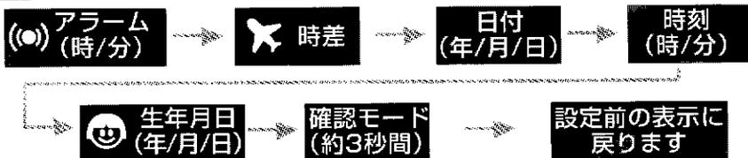
リチウム電池交換後、日時を設定する場合
