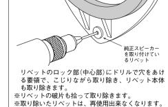
■リベットの除去方法 ●純正スピーカーがリベットで固定されている場合
