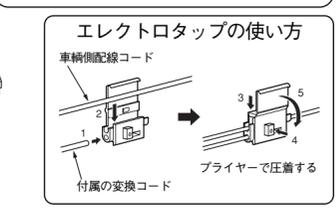
※⊕ ⊖各々極性を合せて接続します。付属変換コードの灰色ライン側 ⊕極性
