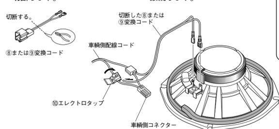
⚠ 使わない端子、または、切断したコードの先端部分はビニールテープ等で巻いて絶縁します。絶縁しないとショートの恐れがあります。
