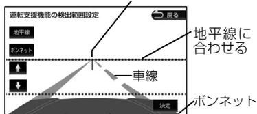
9 [地平線] をタッチして、青点線を [↑] / [↓] で実際の地平線に合わせて微調整する
