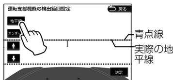
10 [ボンネット] をタッチして、白点線を [↑] / [↓] でボンネットの先端に合わせて [決定] をタッチする
