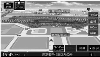
ECOドライブ評点は、少し前からの運転状況をもとに総合評価し、100点満点で表示されます。eスタート、急加速、急減速および経済速度を判定したときもここに表示されます。
