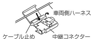
3. ナビ3信号変換ケーブルのリバース検出コードを中継コネクターに差し込みます。
