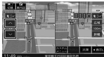
傾き角度調整ボタンをタッチするたびに5度ずつ調整できます。
