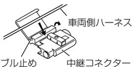
3.ナビ3信号変換ケーブルのリバース検出コードを中継コネクターに差し込みます。
